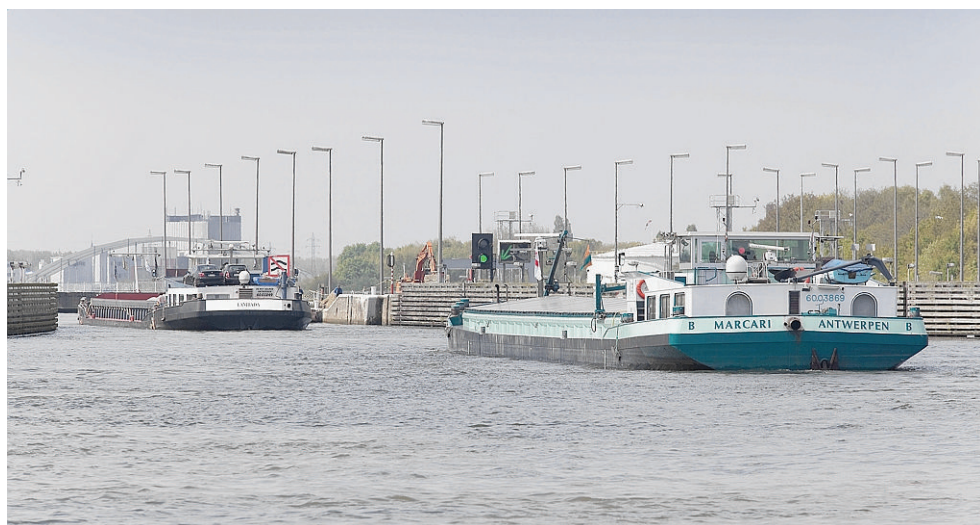
Un lien à grand gabarit - ici le canal Albert, en Belgique -, permet de transporter jusqu'à 4 500 tonnes par convoi, au lieu de 350 tonnes avec un canal à petit gabarit, tel celui de la Marne à la Saône. (photo : VNF)
